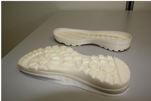
Un prototipo con e senza materiale di supporto
