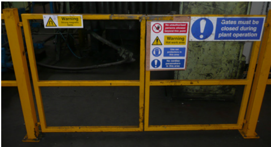
Figura 9.1 — Esempio di un semplice riparo mobile usato per limitare l'accesso a un forte campo magnetico. In questo caso il riparo non è interbloccato ma è integrato da cartelli di avvertimento e misure organizzative
