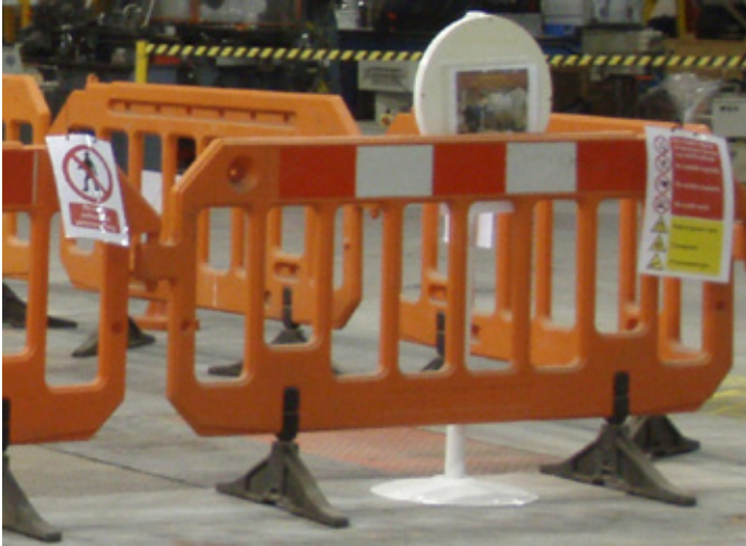
Figura 9.5 — Barriere temporanee e cartelli di avvertimento per limitare l'accesso a campi di elevata intensità generati da un'installazione temporanea
