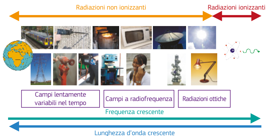
Figura 3.1 — Rappresentazione schematica dello spettro elettromagnetico in cui figurano alcune sorgenti tipiche
